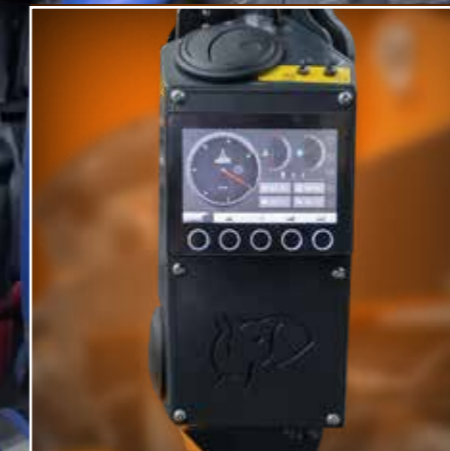
ORDENADOR DE A BORDO PARA CONTROL DEL MOTOR DEUTZ COMPUTADOR DE BORDO PARA CONTROLO DO MOTOR DEUTZ
