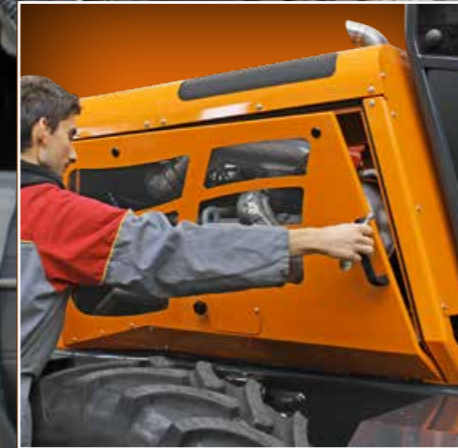
VANO MOTORE DI FACILE ACCESSO PER LA MANUTENZIONE THE ENGINE COMPARTMENT IS EASILY ACCESSIBLE
