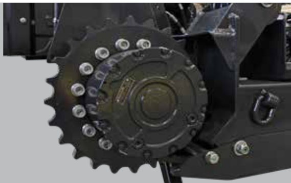
Rueda dentada de la oruga de acero templado Roda dentada do rasto em aço temperado
