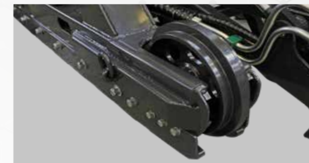
Tensionatore cingolo con molla di sicurezza Track tensioner with safety spring
