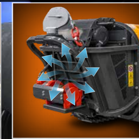
VENTILADOR REVERSIBLE CON AUTOLIMPIEZA FREXXAIRE® VENTOINHA REVERSÍVEL AUTOLIMPANTE FREXXAIRE®
