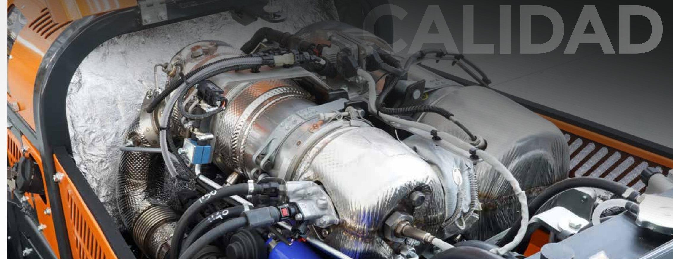
MOTOR DEUTZ DE 100 CV STAGE V MOTOR DEUTZ DE 100 CV STAGE V
