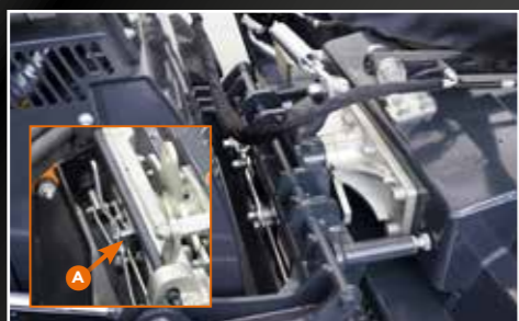
Elevador con acoplamiento rápido con palanca de seguridad (A) Elevador de engate rápido com alavanca de segurança (A)
